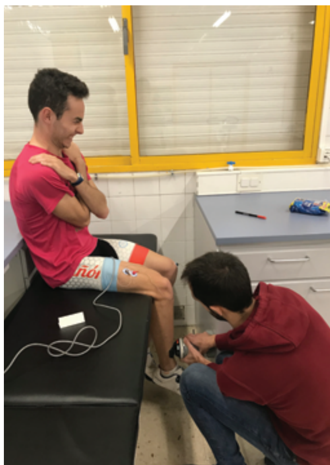
Para medir la fuerza máxima de extensión de rodilla, los sujetos realizan sentados tres contracciones isométricas máximas con la pierna dominante de cinco segundos cada una, evaluando la fuerza mediante un dinamómetro de precisión.
